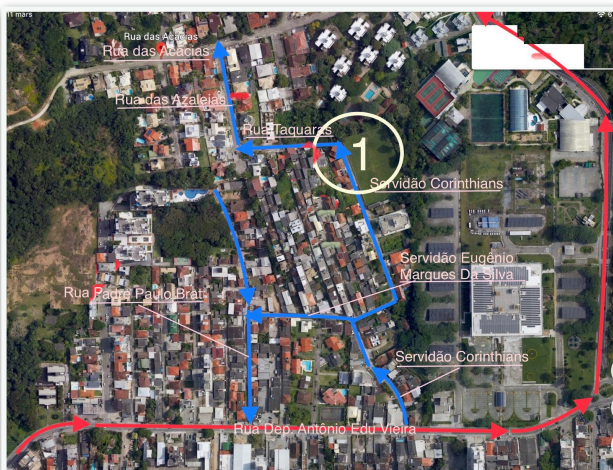
Figura 4: O Binário Pantanal-Carvoeira, indicado em vermelho, contém vias secundárias em azul com baixa porosidade e duas potenciais conexões (1 e 3), que podem reduzir o tempo de viagem do anel. A Potencial Conexão 1 é representada pelo encontro da Rua Taquaras com a Servidão Corinthians. Cabe verificar a situação do terreno e a necessidade de desapropriação do imóvel. Fonte: Gipedu, 2023. Image Google.
